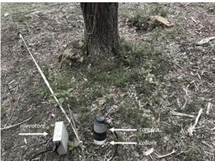
*Collazione del collare in prossimità della pianta e posizionamento della camera per il rilievo delle emissioni di CO<sub>2</sub> dal suolo*
