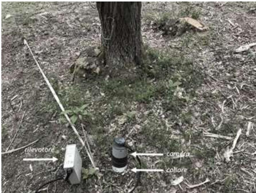
Figura 11. Collazione del collare in prossimità della pianta e posizionamento della camera per il rilievo delle emissioni di CO<sub>2</sub> dal suolo
